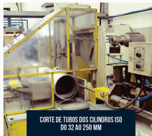
CORTE DE TUBOS DOS CILINDROS ISO DO 32 AO 250 MM
