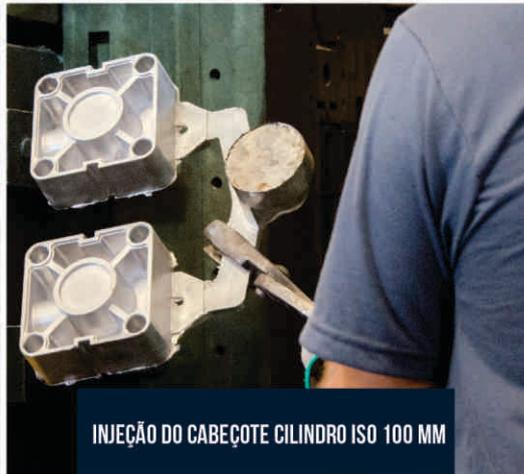
INJEÇÃO DO CABEÇOTE CILINDRO ISO 100 MM
