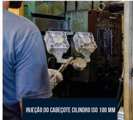
INJEÇÃO DO CABEÇOTE CILINDRO ISO 100 MM
